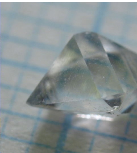
Монокристалл титанил фосфата калия KTiOPO_4 , сегнетоэлектрик и нелинейный оптический кристалл
